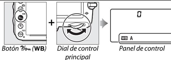
Ajuste con precisión el balance de blancos (□ 117), ajuste la temperatura de color (□ 120) o seleccione un preajuste de balance de blancos (□ 121) en el modo **P**, **S**, **A** o **M**.
