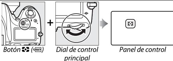
Ajuste la compensación de exposición (modo **P**, **S**, **A**, o **M**; □ 112).
