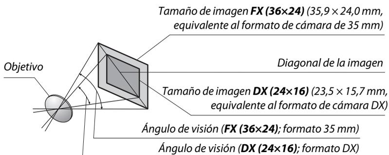
El ángulo de visión **DX (24×16)** es aproximadamente 1,5 veces inferior al del ángulo de visión de formato de 35 mm. Para calcular la distancia focal de los objetivos de formato de 35 mm al seleccionar **DX (24×16)**, multiplique la distancia focal del objetivo por aproximadamente 1,5 (por ejemplo, la distancia focal efectiva de un objetivo de 50 mm en formato 35 mm sería 75 mm al seleccionar **DX (24×16)**).
