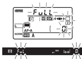
Para cancelar el horquillado, pulse el botón **BKT** y gire el dial de control principal hasta que el indicador de progreso del horquillado y el icono **WB-BKT** ya no se visualicen.
