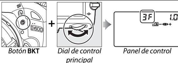
Seleccione el incremento del horquillado (modo **P**, **S**, **A**, o **M**; □ 154).
