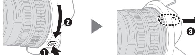
Appuyez sur le bouton de déverrouillage du parasoliel 1 , tournez ce dernier dans le sens indiqué par la flèche 2 et retirez-le comme le montre l'illustration 3 .
