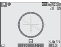
A câmara inclina para a direção transversal.
