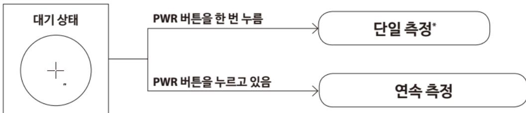
\*측정이 실패하면 결과를 얻을 때까지 최대 약 4초 자동으로 측정을 계속합니다.
