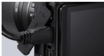
Conecte un cable HDMI al conector HDMI de la cámara
