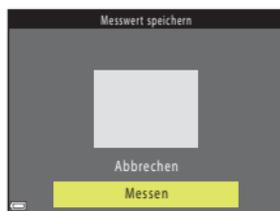
**4** Wählen Sie den Bildausschnitt so, dass sich das weiße bzw. graue Referenzobjekt im Messfenster befindet, und drücken Sie die **OK**-Taste, um den Wert zu messen.
