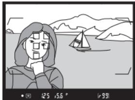
※ [撮像範囲設定] (□82) が [1.3× (18×12)] のときは、左右両端を除く117点のフォーカスポイントを使用してピントを合わせます (□91)。
