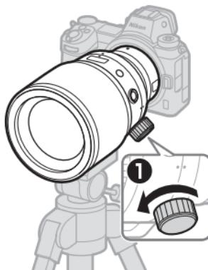
2 Περιστρέψτε τη φωτογραφική μηχανή (2) για να ευθυγραμμίσετε τον δείκτη περιστροφής του φακού με τον δείκτη περιστροφής του κολάρου τριπόδου που ταιριάζει με τον επιθυμητό προσανατολισμό (οριζόντιο ή κατακόρυφο).
