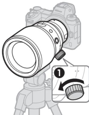
**2** Gire la cámara (2) para alinear el índice de rotación del objetivo con el índice de rotación del collar del trípode que coincide con la orientación deseada (paisaje o retrato).
