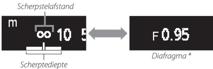
\* Diafragma wordt alleen weergegeven wanneer de camera zich in de stand **A** of **M** bevindt. De weergave voor andere standen wordt getoond in de afbeelding.
