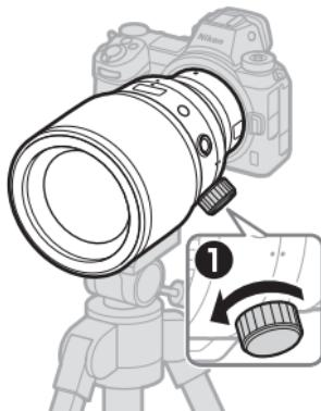
**2** Drehen Sie die Kamera (2), bis die Positionsmarkierung für die Objektivdrehung am passenden Drehindex des Stativrings für die gewünschte Formatlage (Quer- oder Hochformat) steht.
