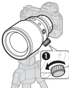
2 Faites pivoter l'appareil photo (2) pour aligner le repère de rotation de l'objectif sur le repère de rotation du collier pour trépied correspondant à l'orientation souhaitée (horizontale ou verticale).
