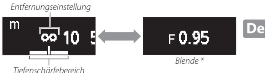
\* Die Blende wird nur angezeigt, wenn sich die Kamera im Modus **A** oder **M** befindet. Die Anzeige für die anderen Modi ist in der Abbildung dargestellt.
