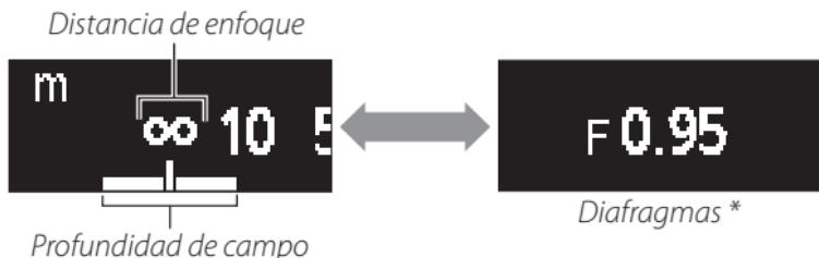
\* Diafragmas se visualiza solamente cuando la cámara se encuentra en el modo **A** o **M**. La visualización para el resto de modos se indica en la ilustración.
