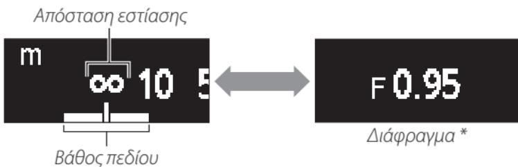
\* Το διάφραγμα εμφανίζεται μόνο όταν η φωτογραφική μηχανή βρίσκεται στη λειτουργία **A** ή **M**. Η οθόνη για άλλες λειτουργίες εμφανίζεται στην εικόνα.
