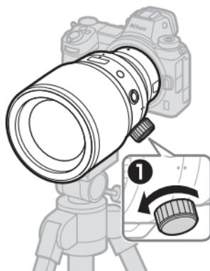
2 Draai de camera (2) om de objectiefrotatie-index uit te lijnen met de statiefkraag die overeenkomt met de gewenste oriëntatie (staand of liggend).
