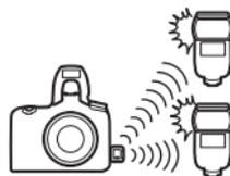
Nel menu di ripresa foto, selezionare **AWL ottica/radio** per **Controllo flash > Opzioni flash wireless** e configurare il flash incorporato e le unità flash remote utilizzando **Controllo flash > Opzioni gruppo flash**, assicurandosi di selezionare -- (No) come modo di controllo flash per il flash incorporato e le unità flash nei gruppi A e B.
