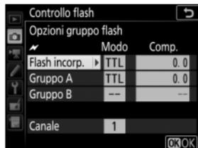
Scegliere un canale per il flash master. Se le unità flash remote includono un'unità SB-500, è necessario scegliere il canale 3, altrimenti è possibile scegliere qualsiasi canale tra 1 e 4.
