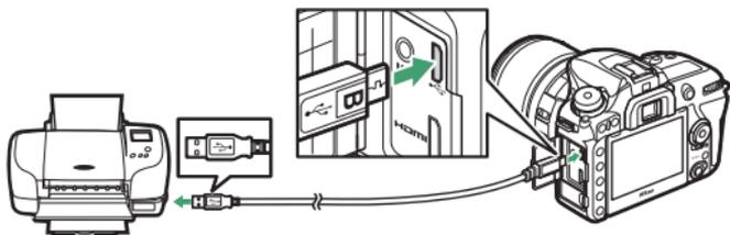
Quando la fotocamera e la stampante vengono accese, viene visualizzata una schermata di benvenuto sul monitor, seguita da un display di riproduzione PictBridge.
