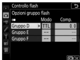
Lo stato delle unità flash radiocontrollate può essere visualizzato anche premendo il pulsante durante la visualizzazione informazioni flash.
