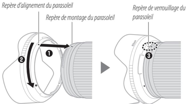
Lorsque vous fixez ou retirez le parasoleil, tenez-le à proximité du repère d'alignement (●) et évitez de le saisir trop fermement à l'avant. Le parasoleil peut être retourné et monté sur l'objectif lorsqu'il n'est pas utilisé.
