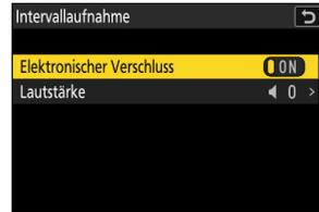
Markieren Sie **[Elektronischer Verschluss]** und drücken Sie **[↻]**, um **[ON]** oder **[OFF]** zu wählen.
