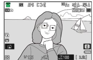
**6 Drücken Sie zum Scharfstellen den Auslöser bis zum ersten Druckpunkt (d. h., drücken Sie den Auslöser leicht an und stoppen Sie, wenn er halb eingedrückt ist).**
