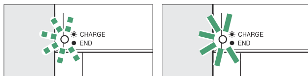
Chargement de l'accumulateur (le témoin clignote)
