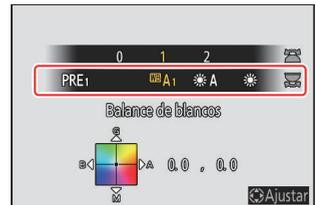
Las opciones para la configuración seleccionada, si hay alguna, se pueden seleccionar manteniendo pulsado el botón **Fn1** y girando el dial secundario.
