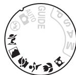
シーンモードは、モードダイヤルを回して設定します。
