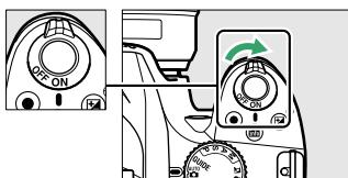
電源スイッチを矢印の方向に回して「OFF」のマークを指標に合わせると、カメラの電源がOFFになります。
